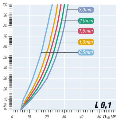
Die Dichtheitsklasse L = 0,1 erlaubt eine maximale Leckage von 0,1 mg Stickstoff pro Sekunde und Meter Dichtungslänge (mg/s x m).
