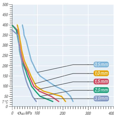
Das obige Diagramm zeigt diese Werte für die unterschiedlichen Dichtungsdicken.
